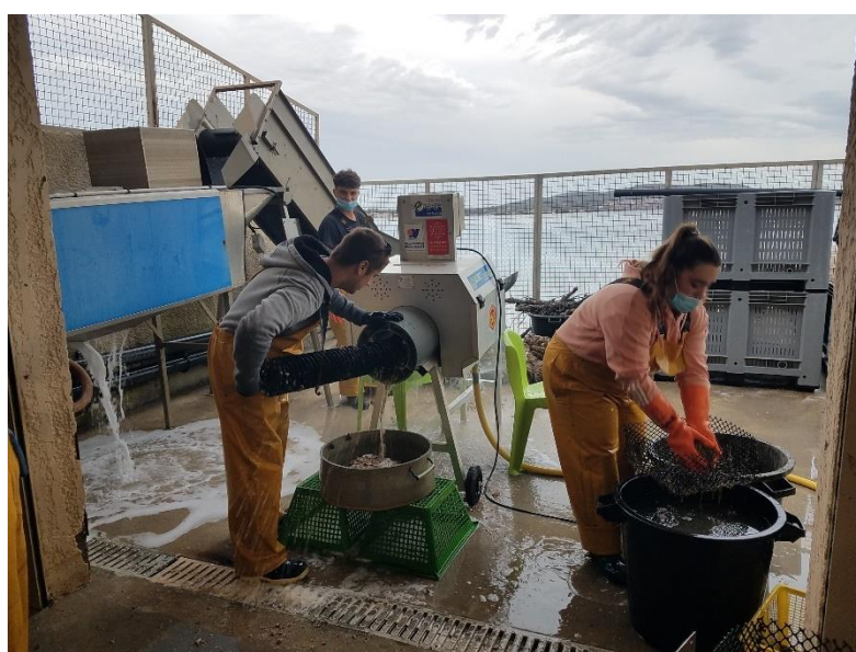
Figure 19 : Assemblage, exondation et détroquage des collecteurs © Cépralmar
