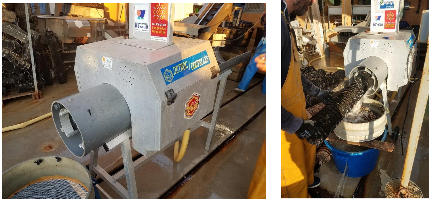
Figure 4 : Détroquage des coupelles à l'aide du détroc' coupelles © Cépralmar
